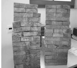
Fig. 2. Delamination on oak test specimens Rys. 2. Rozwarstwienie na próbkach debu
