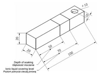
Fig. 2. The sample used for swelling and water absorption tests *Rys. 2. Próbka do badań spęcznienia i nasiąkliwości*
