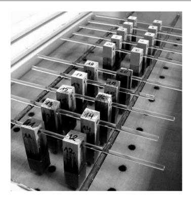
Fig. 3. The samples during soaking in water (unprotected samples at the front) Rys. 3. Próbki podczas moczenia w wodzie (z przodu próbki niezabezpieczone)
