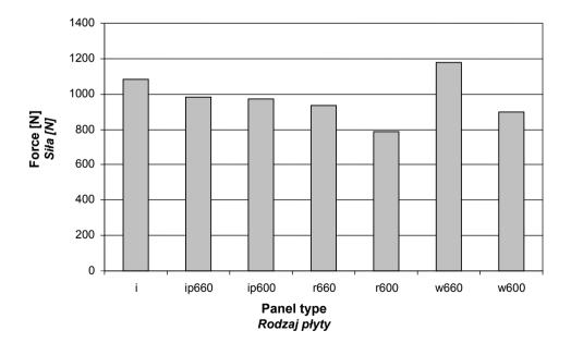
Fig. 1. The screw withdrawal resistance of the investigated panels *Rys. 1. Wytrzymałość badanych płyt na wyciąganie wkręta*
